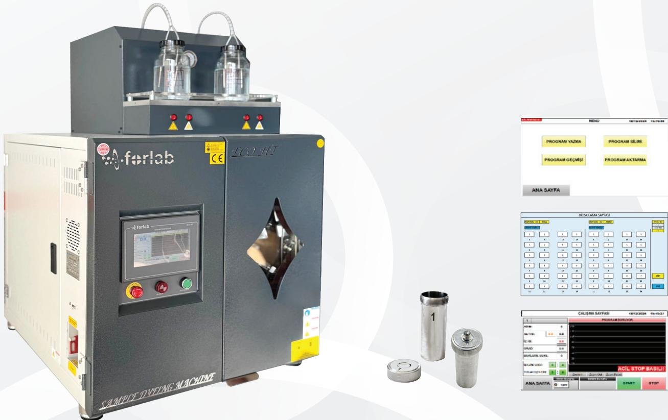
**ECO HT DOSER** numune boyama makineleri tam otomatik dozajlama yapabilen numune boyama makineleridir. Makinelerde dozajlama işlemi her tüp için bağımsız olarak gerçekleşir. 2 adet 1000ml hacminde kimyasal şışeleri ısıtma ve karıştırma özelliği bulunan platform üzerinde bulunur bu sayede kimysallarda donma veya kristalleşme sorunu olmaz. Kimyasal şışelerinde seviye sensörleri bulunur ve minimum seviyeye gelindiğinde kontrol panelinde kullanıcılaraya uyarı verilir.
